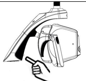
Wenn die Raumleuchte mit der Dentallampe synchronisiert ist, leuchtet die blaue LED an der Raumleuchte konstant. Wenn die LED erlischt, bedeutet dies, dass die Synchronisierung nicht aktiv ist.
