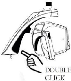
Jedes Mal, wenn ein Doppelklick ausgeführt wird, ändert sich der Tk-Wert der Leuchte. Wiederholen Sie den Vorgang, bis die gewünschte Farbtemperatur auf der Kontrollleuchte angezeigt wird. 2 Pieptöne informieren den Benutzer darüber, dass sich das Tk ändert.
